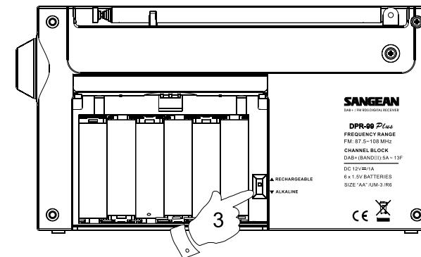
4. La durée nécessaire de mise en charge des piles est d'environ 7 heures.
