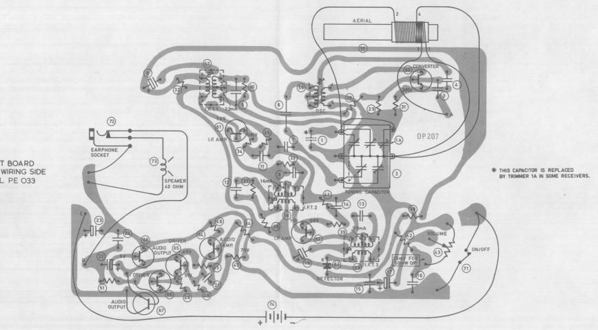
CIRCUIT BOARD PRINTED WIRING SIDE MODEL PE 033
