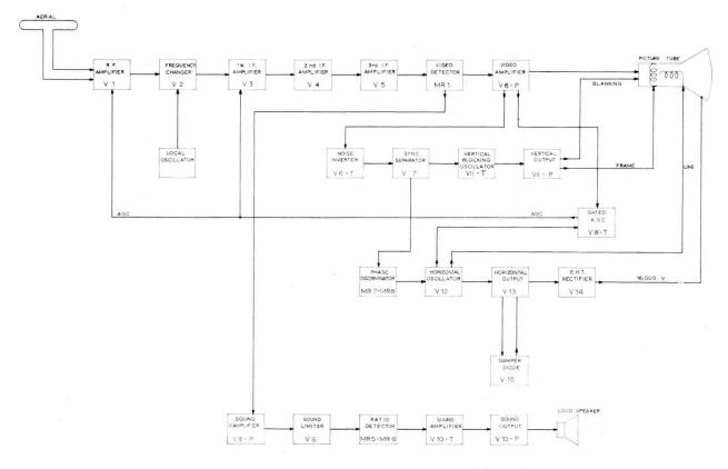
BLOCK DIAGRAM — 15-VALVE CIRCUITS
