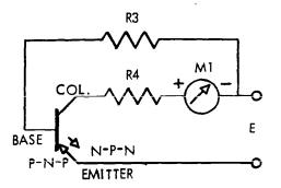
o) TRANSISTOR TEST 2 (Beta)
